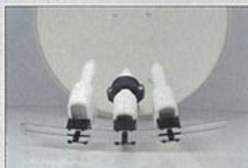
Neben einer horizontalen Ausrichtung durch hin- und herschieben auf der Schiene kann der Konverter auch vertikal bewegt werden
